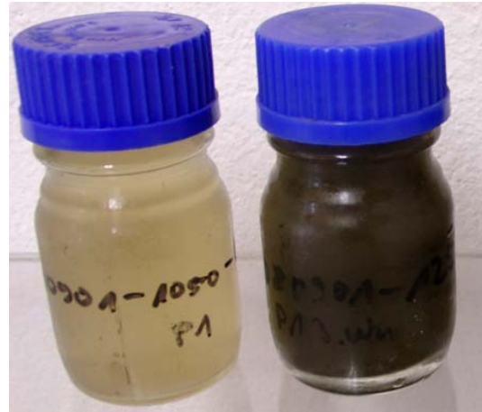
Abbildung 3: Überführung der Schadstoffe in das Prozesswasser (links vor und rechts nach der Bodenwäsche)..
